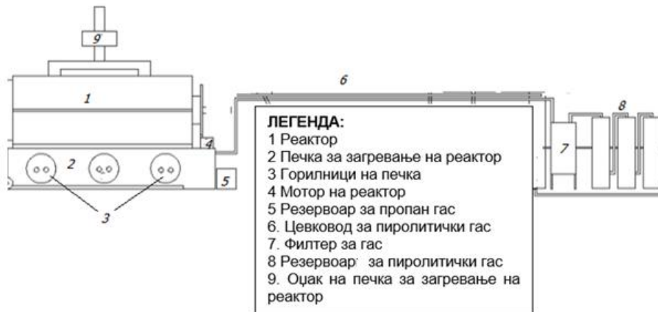
Слика 17 Шематски приказ на производство на пиролитички гас
