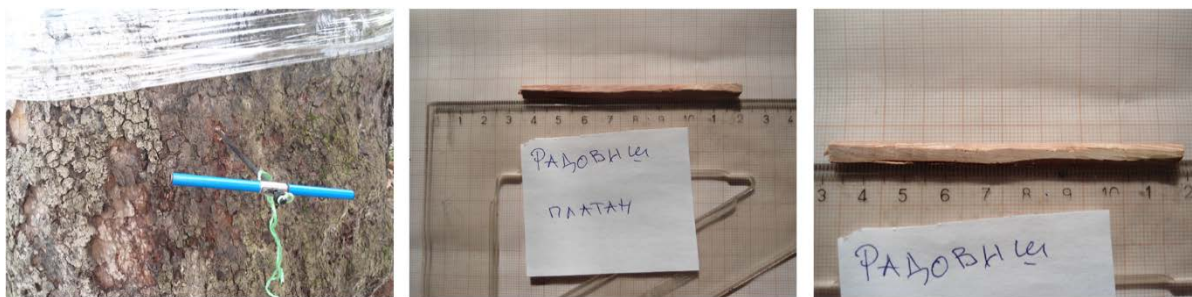
Слика 1 Земање изврткок од платановото стебло со Преслеров сврдел и утврдување на возраста со броење и мерење на годовите од изврткокот
