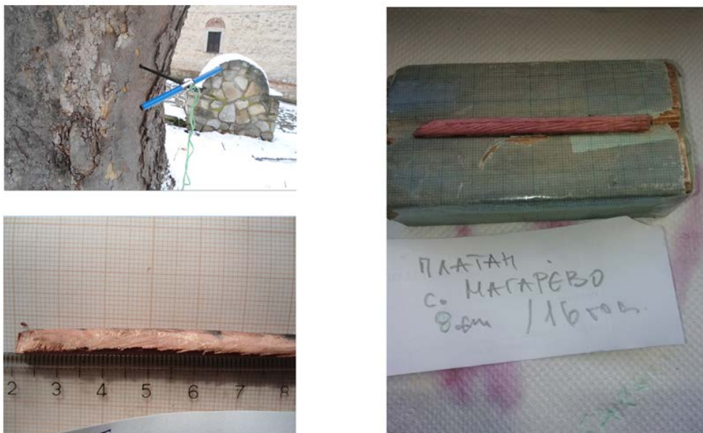
Слика 1 Земање изврткок од платановото стебло со Преслеров сврдел и утврдување на возраста со броење и мерење на годовите од извртокот
