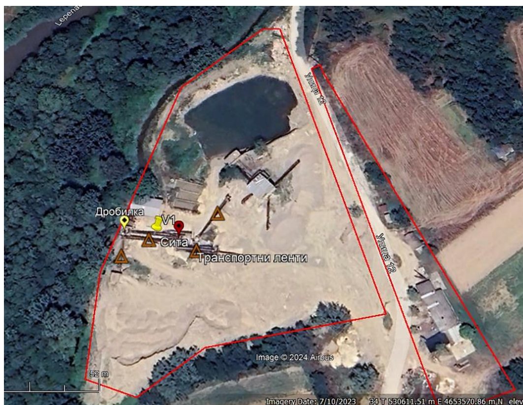
Слика 4 Стационарен извор на вибрации во Инсталацијата - линија за сепарација и дробење со составни делови
