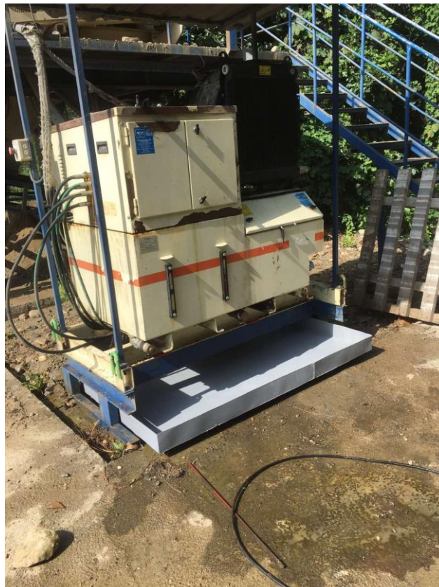
Слика 19 Систем за автоматско подмачкување со хидраулично масло
