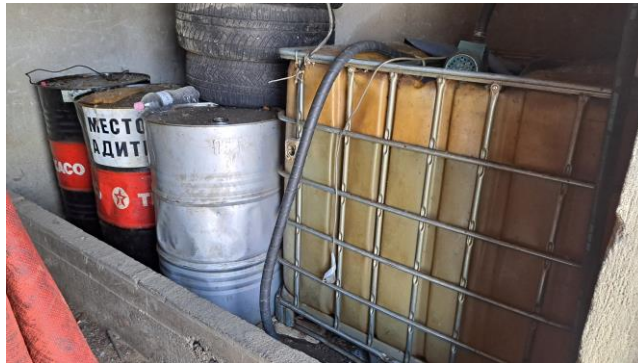
Слика 3 Складирање на дизел гориво, масла и масти во танквана
