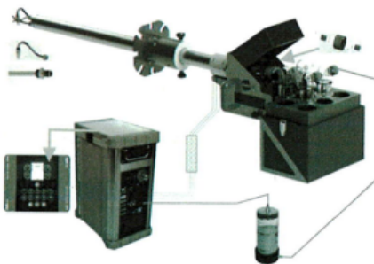
Слика бр.4 Инструмент за изокинетско мострирање - тип DADO LAB-ST5
