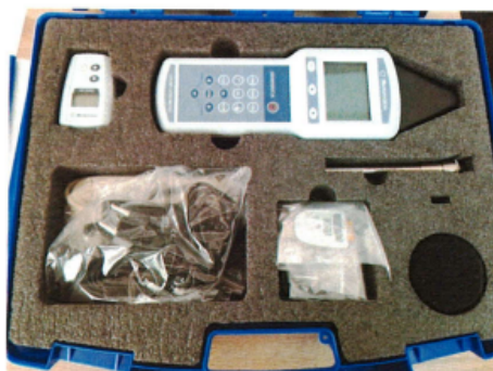
Слика бр.1; Инструмент за определување на ниво на Бучава Sound level meter: Delta Ohm, type HD2010PNE2
