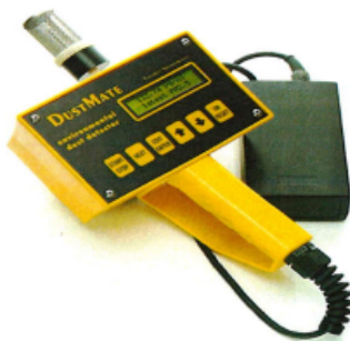
Слика бр.2; Инструмент за мерење на ниво на Квалитет на воздух - определување на вкупни суспендирани честици, респирабилни честици и фракција на ПМ 10 и ПМ 2.5 честици - тип TURNKEY DustMate kit
