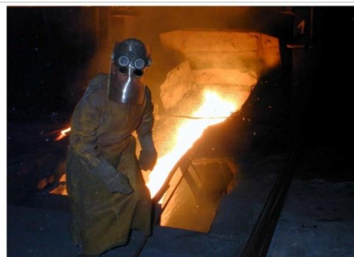
Течење на троската од електропечка
